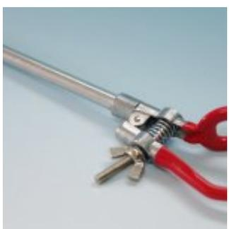
La Pinza de Laboratorio se considera generalmente como una herramienta de metal dentro de un laboratorio químico. Esta permite sostener firmemente diferentes objetos mediante el uso de una doble nuez ligada a un soporte universal. La pinza se compone dos brazos o tenazas, que aprietan el cuello de los frascos u otros materiales de vidrio mediante el uso de tornillos que pueden ajustarse manualmente.
