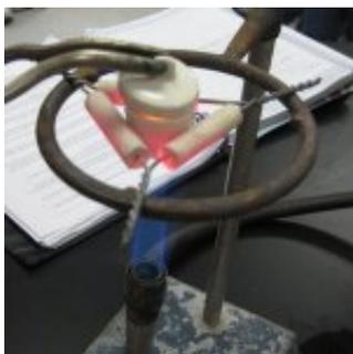
El Triángulo de Porcelana es un instrumento de laboratorio utilizado en procesos de calentamiento de sustancias. Se utiliza para sostener crisoles cuando estos deben ser calentados.
