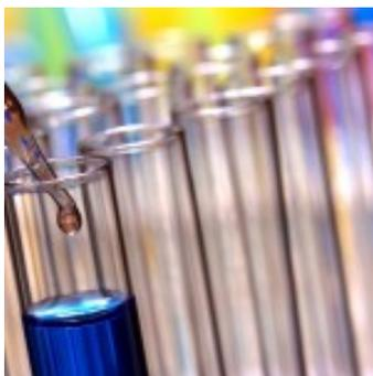
El tubo de ensayo forma parte del material de vidrio de un laboratorio químico. Este instrumento permite la preparación de soluciones. Es un pequeño tubo de vidrio con una abertura en la zona superior, y en la zona inferior es cerrado y cóncavo.
