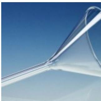
Un embudo es una pieza cónica de vidrio o plástico que se utiliza para el trasvasado de productos químicos desde un recipiente a otro. También es utilizado para realizar filtraciones.
