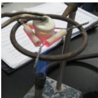
El Crisol de Porcelana es un material de laboratorio utilizado principalmente para calentar, fundir, quemar, y calcinar sustancias. La Porcelana le permite resistir altas temperaturas.
