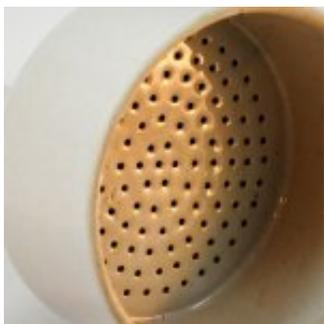
El Embudo Büchner es un tipo especial de embudo utilizado para la filtración al vacío o filtración a presión asistida. Se hace tradicionalmente de porcelana, sin embargo también está disponible en vidrio y plástico. En la zona superior cilíndrica del embudo existe una placa circular que posee un conjunto de perforaciones.
