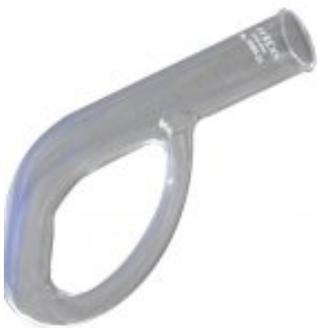
El Tubo de Thiele se utiliza principalmente en la determinación del punto de fusión de una determinada sustancia. Para esto se llena de un líquido con un punto de fusión elevado, y se calienta. Su peculiar forma hace que las corrientes de convección formadas por el calentamiento, mantengan todo el tubo a temperatura constante.
