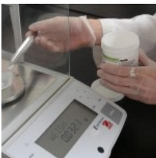
La balanza analítica es uno de los instrumentos de medida más usados en laboratorio y de la cual dependen básicamente todos los resultados analíticos. Las balanzas analíticas modernas, que pueden ofrecer valores de precisión de lectura de  $0,1 \mu\text{g}$  a  $0,1 \text{mg}$
