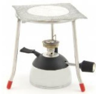
La finalidad que cumple el trípode de laboratorio es solo una. Este es utilizado principalmente como una herramienta que sostiene la rejilla de asbesto. Con este material es posible la preparación de montajes para calentar, utilizando como complementos el mechero (dependiendo del tipo). También sirve para sujetar con mayor comodidad cualquier material que se use en el laboratorio que vaya a llenarse con productos peligrosos o líquidos de cualquier tipo.
