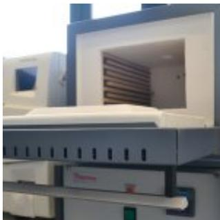
Una mufla es un horno destinado normalmente para la cocción de materiales cerámicos y para la fundición de metales a través de la energía térmica. Dentro del laboratorio un horno mufla se utiliza para calcinación de sustancias, secado de sustancias, fundición y procesos de control.
