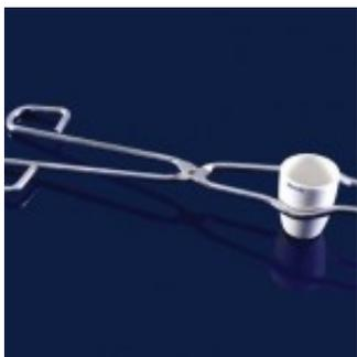
La pinza de crisol es una herramienta de acero inoxidable y su función es sostener y manipular capsulas de evaporación, crisoles y otros objetos. Se utiliza principalmente como medida de seguridad cuando estos son calentados o poseen algún grado de peligrosidad al manipularlos directamente.
