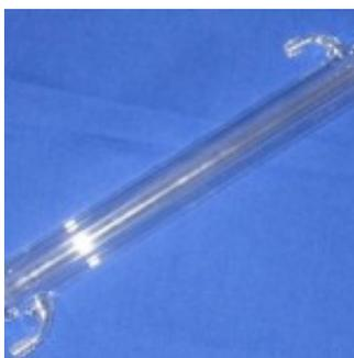
El Tubo Refrigerante o Tubo condensador, es un aparato de vidrio que permite transformar los gases que se desprenden en el proceso de destilación, a fase líquida. El tubo Refrigerante está conformado por dos tubos cilíndricos concéntricos. Por el conducto interior del tubo circulara el gas que se desea condensar y por el conducto más externo circulara el líquido refrigerante.
