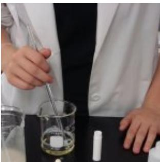
La Varilla de Agitación es un fino cilindro de vidrio macizo, que se utiliza principalmente para mezclar o disolver sustancias con el fin de homogenizar. Generalmente su diámetro es de 6mm y longitud es de 40cm.
