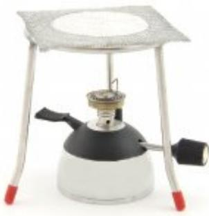
La Rejilla de Asbesto es la encargada de repartir la temperatura de manera uniforme cuando esta se calienta con un mechero. Para esto se usa un trípode de laboratorio, ya que sostiene la rejilla mientras es calentada. La rejilla de Asbesto se debe colocar sobre el trípode y bajo el mechero.
