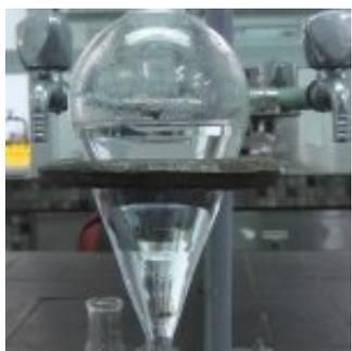
El embudo de decantación se utiliza principalmente para separar líquidos inmiscibles, o insolubles (no se mezclan) que se separan, por diferencia de densidades y propiedades moleculares que estos líquidos poseen. La cual mediante un tiempo se apartan en dos o más fracciones dependiendo de la cantidad de productos contenidos al interior del recipiente.
