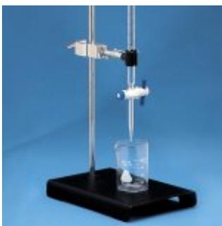
Herramienta de metal que se une al soporte universal para sujetar verticalmente una sola bureta. También puede sostener otros materiales de vidrio como tubos de ensayo, frascos, entre otros.
