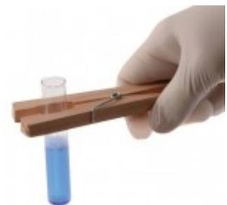
Esta herramienta sirve para sujetar los tubos de ensayos, mientras estos se calientan o cuando se trabaja directamente con ellos.
