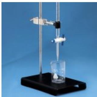
La Bureta se utiliza para emitir cantidades variables de líquido con gran exactitud y precisión. La Bureta es un tubo graduado de gran extensión, generalmente construido de vidrio. Posee un diámetro interno uniforme en toda su extensión, esta provista de una llave o adaptadas con una pinza de Mohr, que permite verter líquidos gota a gota.
