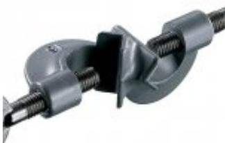
La finalidad que tiene la doble nuez es sujetar otras herramientas, como una argolla metálica o una pinza de laboratorio, la cual a su vez debe sujetarse en un soporte universal.
