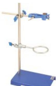
El Soporte Universal es una herramienta que se utiliza en laboratorio para realizar montajes con los materiales presentes en el laboratorio permitiendo obtener sistemas de medición y preparar diversos experimentos. Está conformado por una base o pie rectangular, el cual permite soportar una varilla cilíndrica que permite sujetar diferentes materiales con ayuda de dobles nueces y pinzas.
