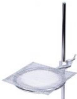
La Argolla Metálica es considerada como una herramienta de metal dentro de un laboratorio químico. Esta provee soporte para sostener otros materiales, permitiendo la preparación de diferentes entornos de trabajo. La Argolla Metálica de laboratorio se sujeta directamente con el soporte universal utilizando un tornillo que puede ajustarse manualmente. En la Argolla se pueden posar diferentes materiales (por ejemplo: un embudo o una rejilla de asbesto).
