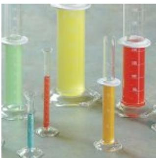
Tubo de cristal alargado y graduado, cerrado por un extremo, usado como recipiente de líquidos o gases, el cual tiene como finalidad medir el volumen de los mismos.
