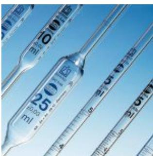
Las pipetas permiten la transferencia de un volumen generalmente no mayor a 20 ml de un recipiente a otro de forma exacta. Este permite medir alícuotas de líquido con bastante precisión. Suelen ser de vidrio. Está formado por un tubo transparente que termina en una de sus puntas de forma cónica, y tiene una graduación (una serie de marcas grabadas) indicando distintos volúmenes.
