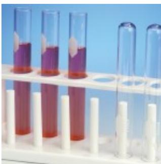
Una gradilla es un utensilio utilizado para dar soporte a los tubos de ensayos o tubos de muestras. Normalmente es utilizado para sostener y almacenar los tubos. Este se encuentra hecho de madera, plástico o metal.
