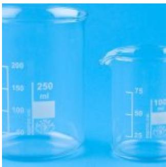
Un vaso de precipitado tiene forma cilíndrica y posee un fondo plano. Se encuentran en varias capacidades. Se encuentran graduados. Pero no calibrados, esto provoca que la graduación sea inexacta. Son de vidrio y de plástico (Cuando están hechos de vidrio se utiliza un tipo de material mucho más resistente que el convencional denominado pyrex). Posee componentes de teflón y otros materiales resistentes a la corrosión. Su capacidad varía desde el mililitro hasta el litro (o incluso más).
