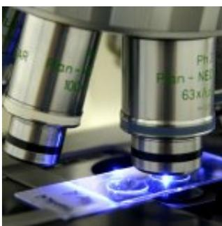
Lámina de vidrio rectangular de color transparente utilizada para almacenar muestras y objetos con el fin de observarlas bajo el microscopio. Las dimensiones típicas de un portaobjeto son de 75mm x 25mm, sin embargo están pueden variar dependiendo del tipo de objeto o muestra (en geología suelen utilizarse portaobjetos de 75 x 50 mm).
