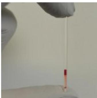
Un Tubo Capilar es un tubo de vidrio de diámetro muy pequeño y corta longitud. El diámetro interno del tubo es utilizado para demostrar los efectos de la capilaridad.
