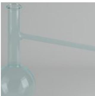
El Balón de Destilación se utiliza principalmente para separar líquidos mediante el proceso de destilación. La Destilación es un proceso de separación basado en la diferencia de los puntos de ebullición de los componentes de una mezcla.
