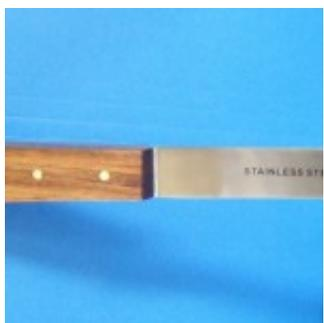
La espátula es una lámina plana angosta que se encuentra adherida a un mango hecho de madera, plástico o metal. Es utilizada principalmente para tomar pequeñas cantidades de compuestos o sustancias sólidas, especialmente las granulares.
