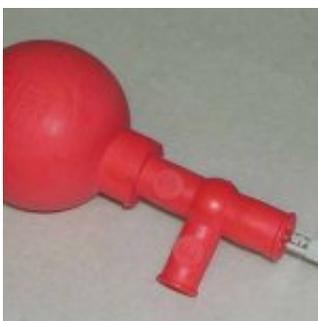
Utensilio de goma, creada especialmente para asegurar la transferencia de líquidos de todo tipo, especialmente los que poseen propiedades específicas (infecciosos, corrosivos, tóxicos, radiactivos o estériles). Se utiliza en conjunto con la pipeta.
