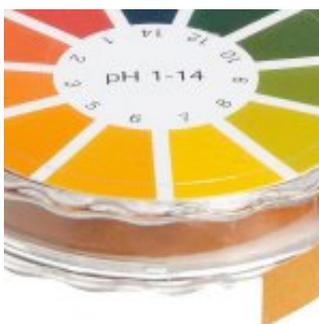
El Papel tornasol o Papel pH es utilizado para medir la concentración de Iones Hidrógenos contenido en una sustancia o disolución. Mediante la escala de pH, la cual es clasificada en distintos colores y tipos.
