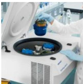
La centrífuga es un equipo de laboratorio que genera movimientos de rotación, tiene el objetivo de separar los componentes que constituyen una sustancia. Hoy en día hay existe una diversidad de centrifugas que tiene diferentes objetivos, independientemente del tipo de investigación o industria.
